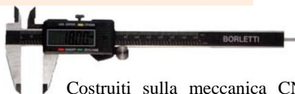
Costruiti sulla meccanica CN15-CN20 con asta arrotondata. Sistema di misura incrementale – assoluto (INC/ABS) e rotella di trascinamento corsoio. Vite di bloccaggio. Sono dotati di pulsante di azzeramento, di pulsante di conversione immediata mm/pollici.
