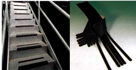
Pellicola autoadesiva con granuli abrasivi legati da resine sintetiche, cosparsi su un robusto supporto in poliestere. Indicato per tutte le superfici pedonali o veicolari (scale, ingressi, condomini, rampe, passerelle) Sulle superfici porose applicare uno strato di primer 776. Spessore GP nero: 0,8 mm
