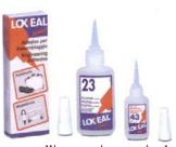
**UTILIZZO:** Adesivi cianoacrilici per **fissaggio istantaneo** e **strutturale** di gomma, metalli, ceramica, cuoio, legno, materie plastiche. È opportuno che le superfici da incollare combacino perfettamente, i migliori risultati si ottengono con giunzioni inferiori a 0,1 mm; si può arrivare a spessori di 0,30 mm utilizzando prodotti densi o in gel. Il campo operativo di temperatura è compreso fra -50°C e + 80°C con punte sino a 130°C con prodotti speciali.
