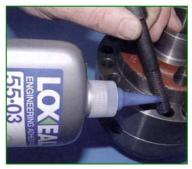
**UTILIZZO:** Per **bloccare e frenare** bulloni, dadi, viti prigionieri e **parti filettate in genere**. **Evitano allentamenti** dovuti a vibrazioni, urti, sbalzi di temperatura. Eliminano corrosione e grippaggio. Facilitano l'avvitamento delle parti filettate. Sostituiscono le classiche rondelle, grover, rosette. Sono disponibili **vari gradi di resistenza e sviamento**.
